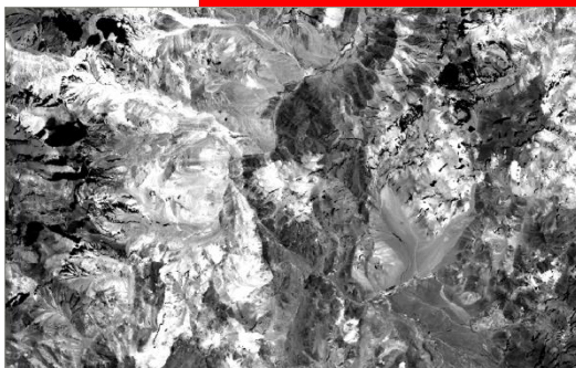
Ilustración 27. Monobandas en tonos de grises y combinación falso color compuesta (FFC) de las bandas 5-4-3. Zona de Veladero. Imagen Landsat 5 TM. Fuente: Elaboración propia.
