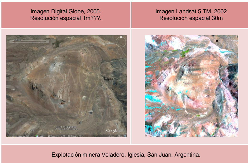
Ilustración 23. Comparación de resolución espacial para la mina Veladero. Fuente: Elaboración propia.
